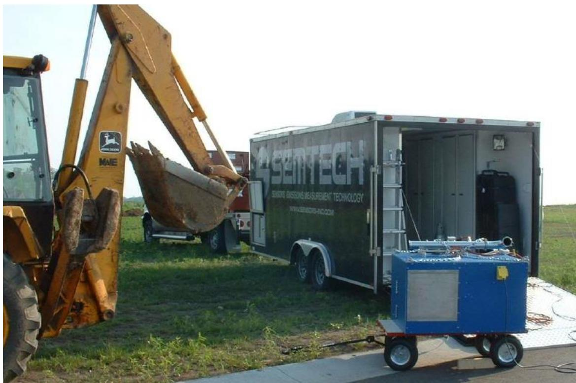
*Slika 10.2. Primjer mobilnog mjernog laboratoriјa za određivanje emisije štetnih tvari motora velikih dimenzija*
