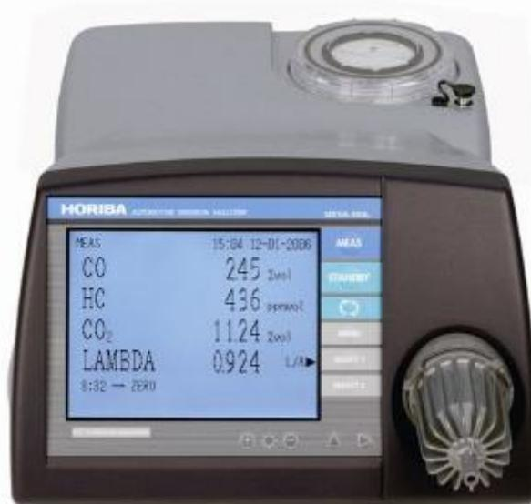
Slika 8.4. Horiba MEXA – 584L mjerni uređaj[14]
