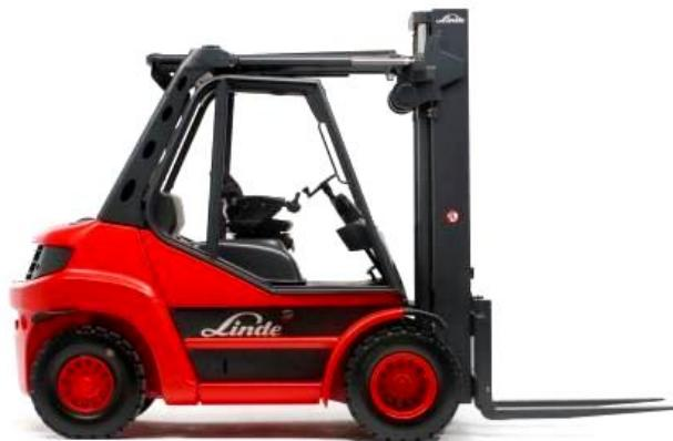
*Slika 4.1. Viličar Linde H80D pogonjen Dieselovim motorom snage 85kW [6]*
