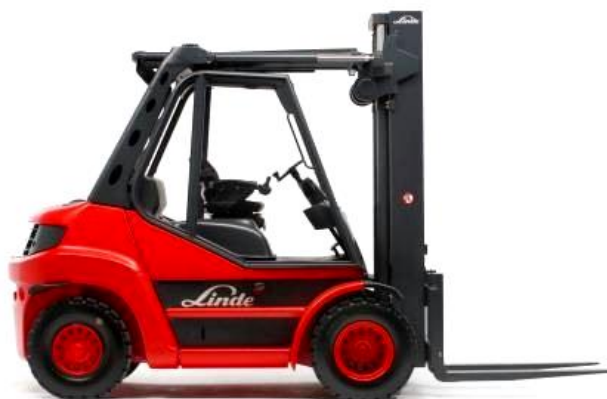
Slika 4.1. Viličar Linde H80D pogonjen Diesellovim motorom snage 85kW [6]
