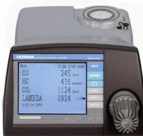
Slika 8.4. Horiba MEXA – 584L mjerni uređaj[14]
