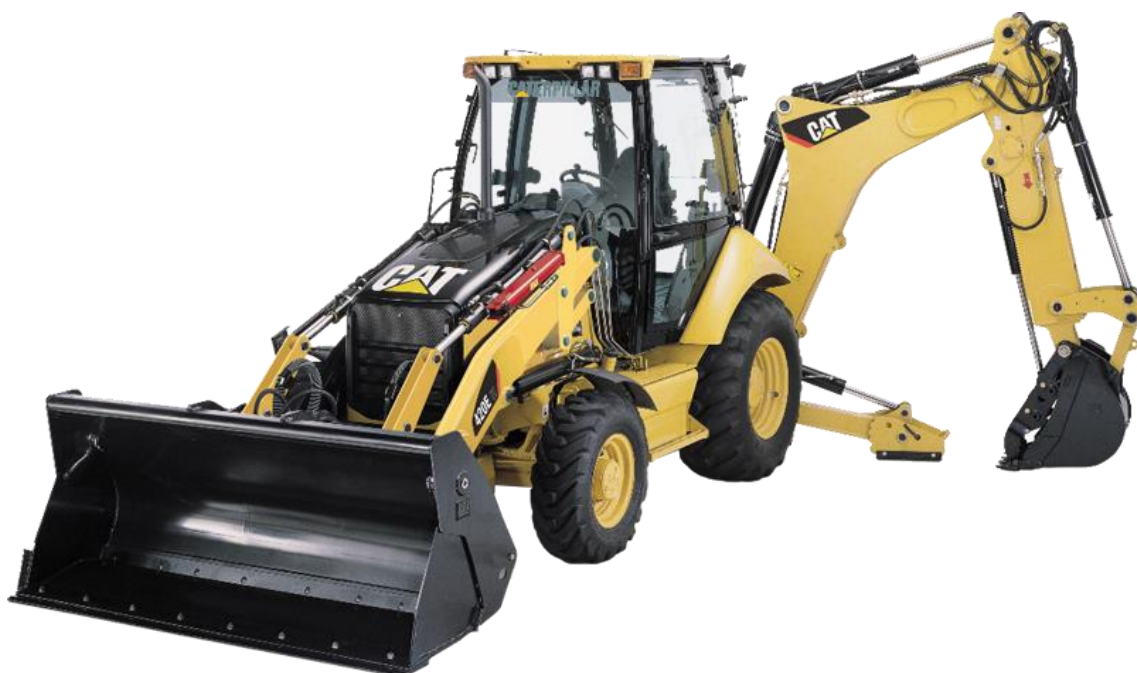
Slika 4.2. Caterpillar 434E rovokopač pogonjen Diesellovim motorom snage 68,5 kW [5]
