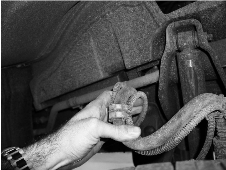
Slika 3.14 Provjera kočnih crijeva
