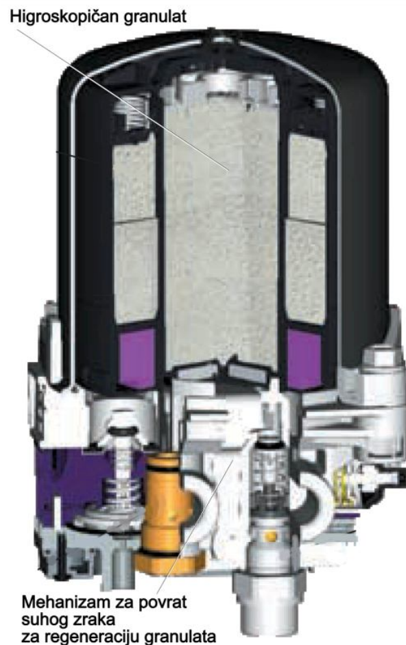
Slika 3.8 Isušivač zraka
