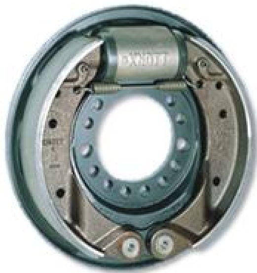
Slika 1.3 Simplex kočioni sustav
