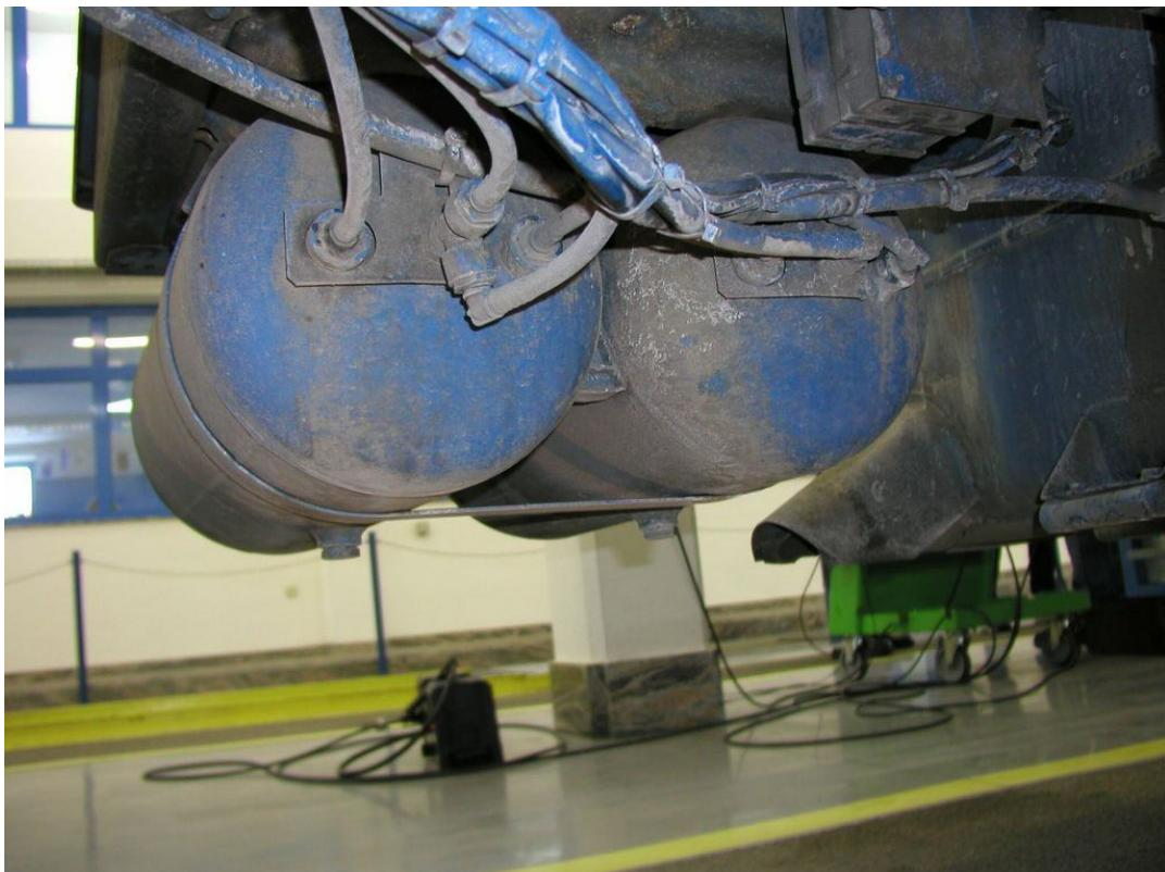
*Slika 3.6 Spremnići zraka na vozilu*
