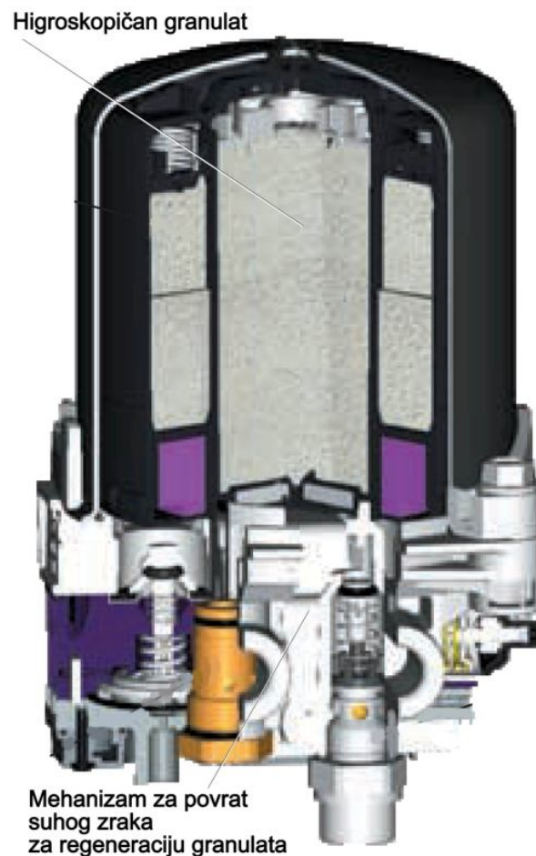
Slika 3.8 Isušivač zraka
