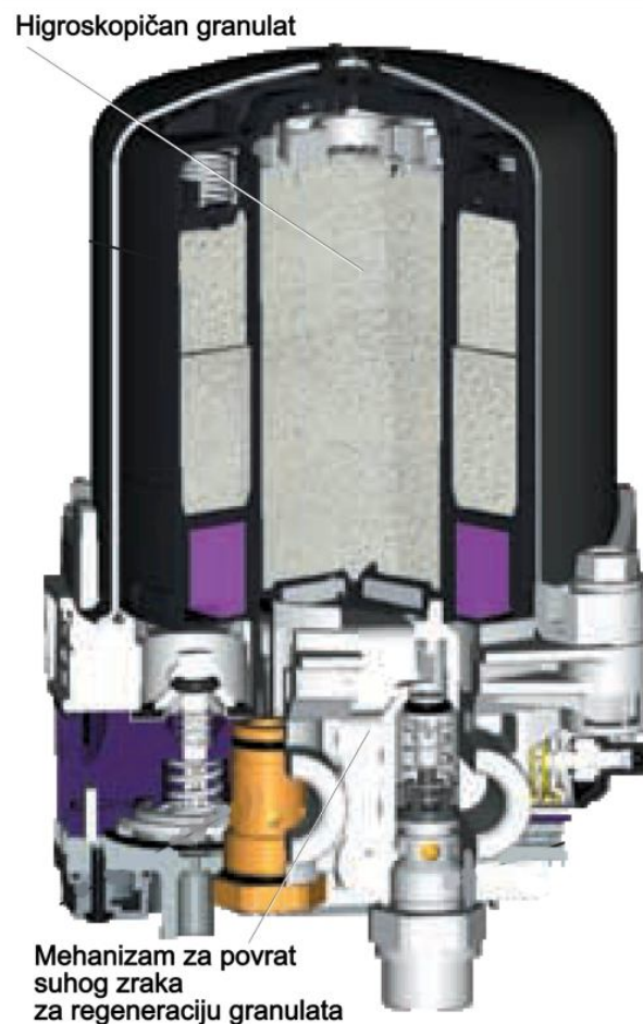
Slika 3.8 Isušivač zraka
