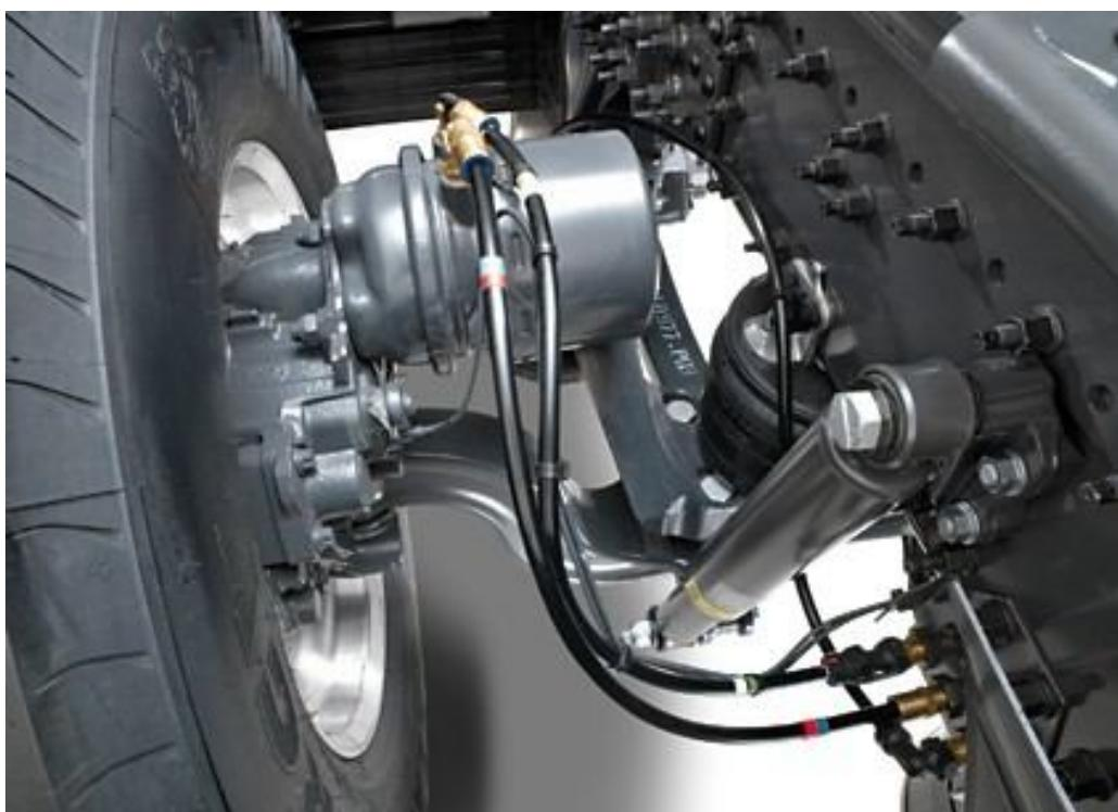
Slika 3.11 Tristop kočni cilindar
