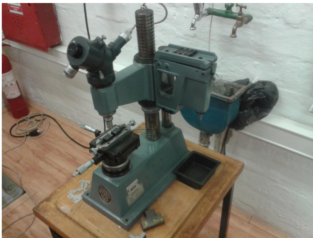
Slika 21. Uređaj za mjerenje tvrdoće po Vickersu
