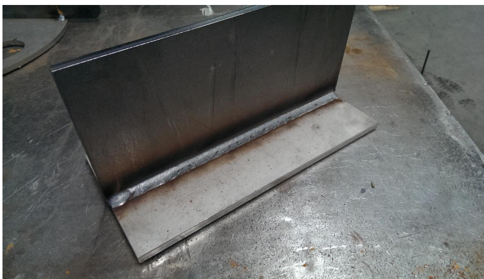
Slika 16. Zavareni ispitni uzorak s jednim prolazom
