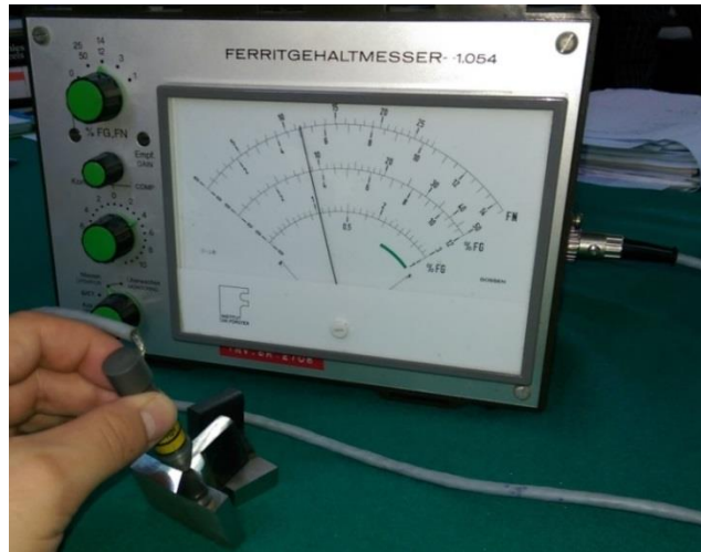
Slika 21. Uređaj za mjerenje feritnog broja
