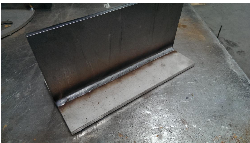
Slika 16. Zavareni ispitni uzorak s jednim prolazom
