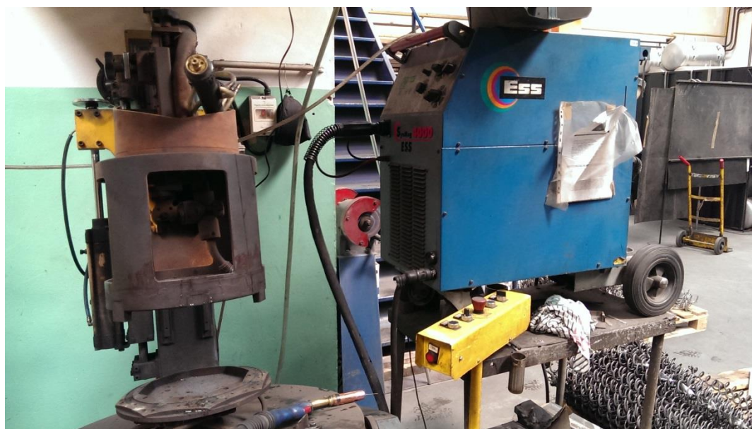
Slika 11. Izvor struje za zavarivanje ESS SynMag 4000
