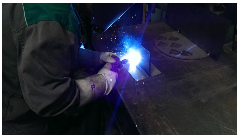
Slika 14. Zavarivanje ispitnog uzorka s jednim prolazom
