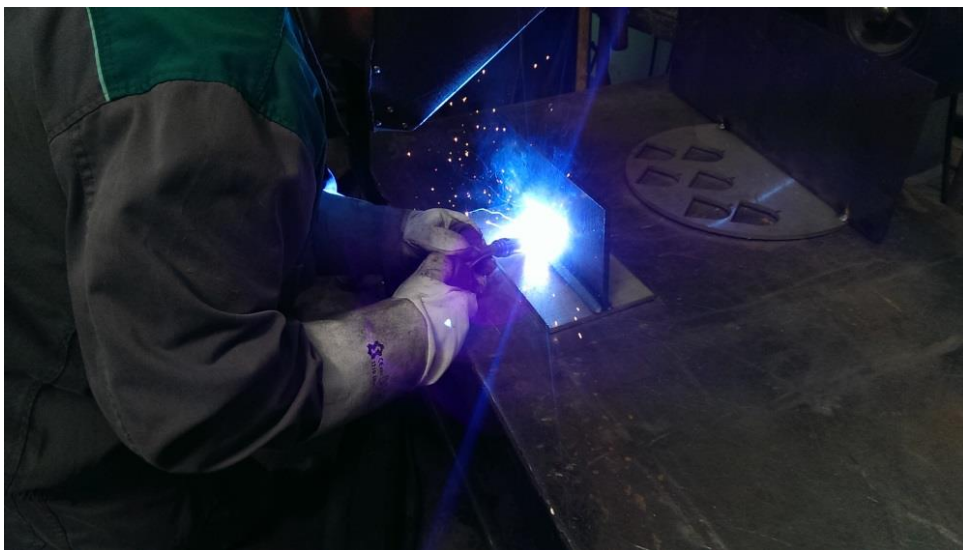
Slika 14. Zavarivanje ispitnog uzorka s jednim prolazom
