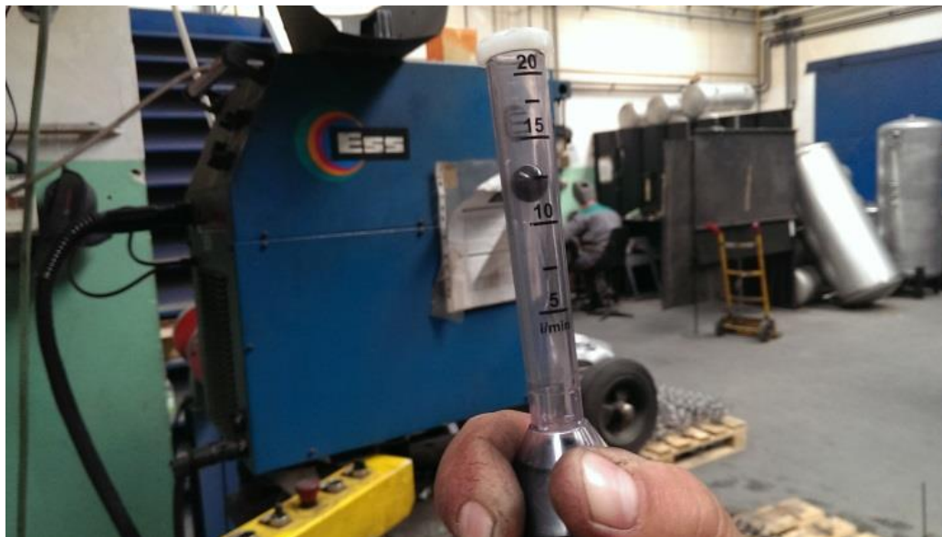
Slika 12. Provjera protoka plina
