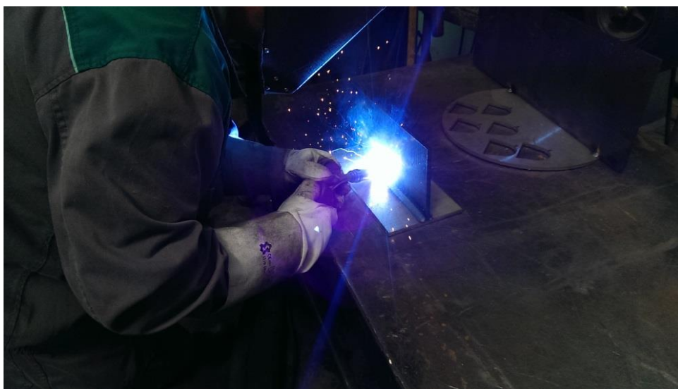
Slika 14. Zavarivanje ispitnog uzorka s jednim prolazom
