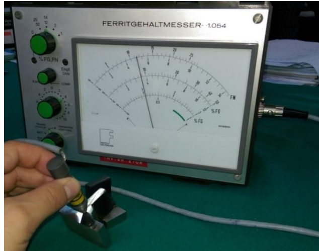
Slika 21. Uređaj za mjerenje feritnog broja
