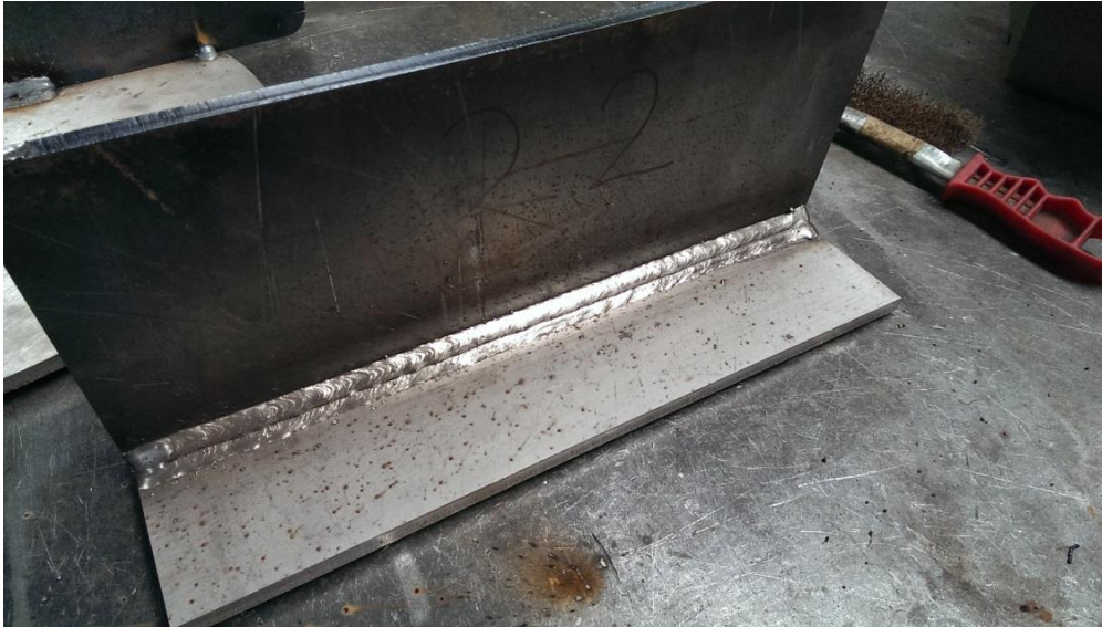
Slika 17. Zavareni ispitni uzorak s tri prolaza
