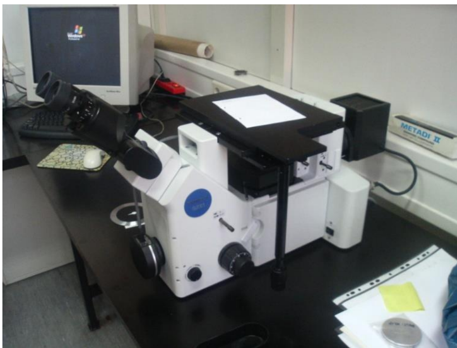
Slika 9. Svjetlosni mikroskop OLYMPUS GX51.
