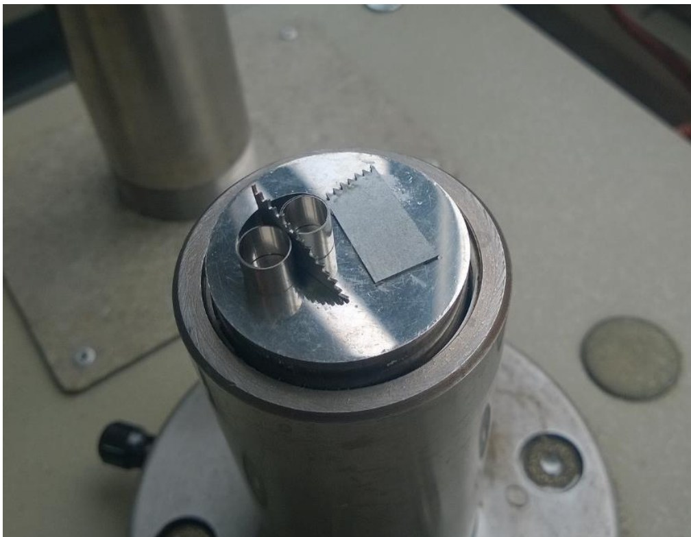
Slika 6. Prikaz uzoraka na preši prije kapsuliranja
