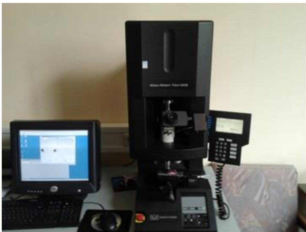
Slika 16. Mikrotvrdomjer WILSON-WOLPERT TUKON 2100 B proizvođača INSTRON.
