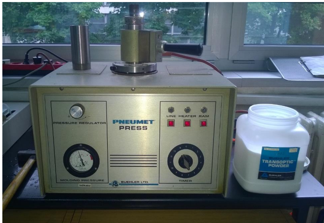
Slika 7. Prikaz uređaja za kapsuliranje.
