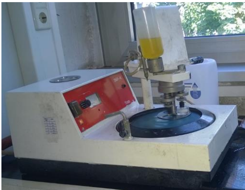
Slika 8. Prikaz uređaja za poliranje.
