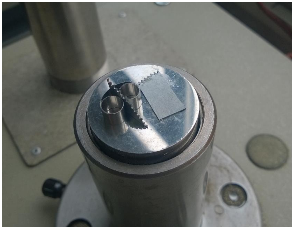
Slika 6. Prikaz uzoraka na preši prije kapsuliranja
