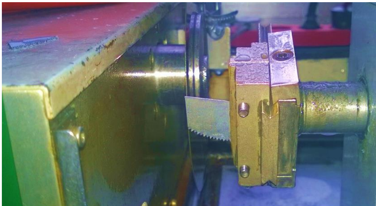
Slika 5. Prikaz postupka izrezivanja dijela uzorka pile.
