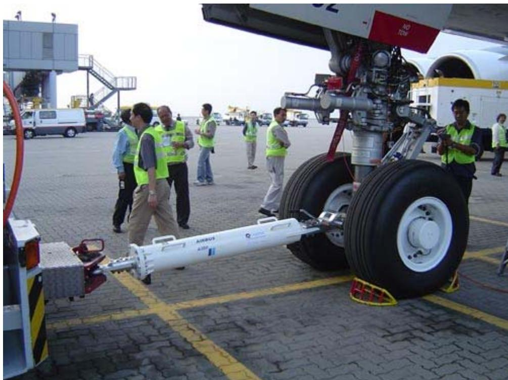
Slika 2.1 Vuča zrakoplova pomoću vučnog ruda
