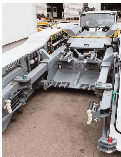
Slika 3.2 Podizna rampa vučnog vozila Goldhofer AST-2
