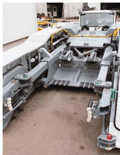
Slika 3.2 Podizna rampa vučnog vozila *Goldhofer AST-2*
