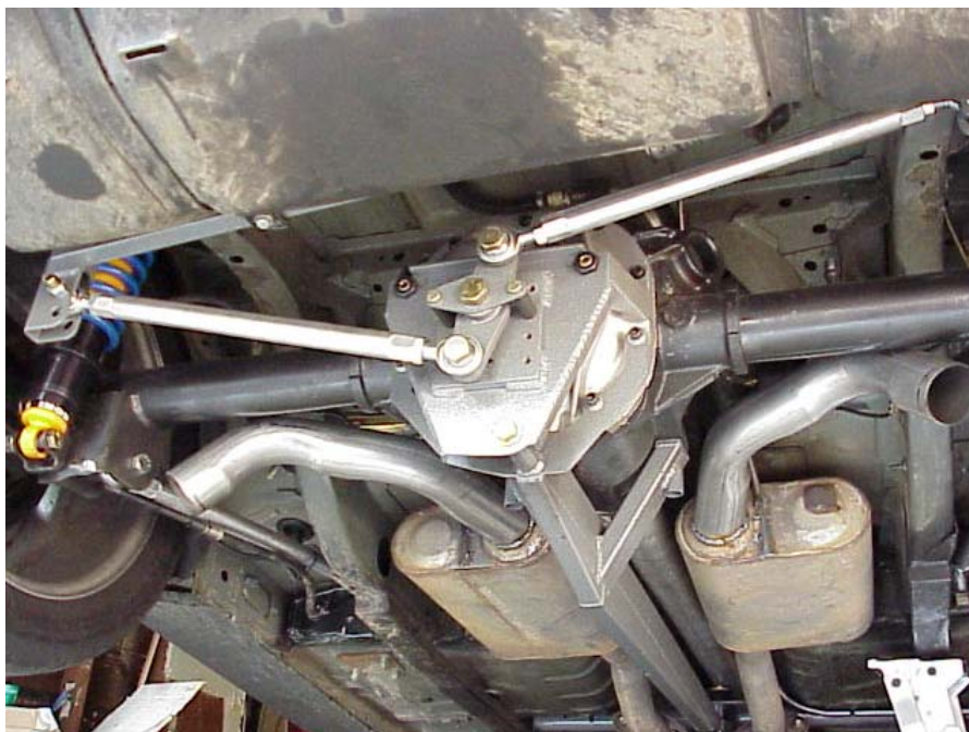
Slika 4.3 Wattov mehanizam kao element automobilskog ovjesa
