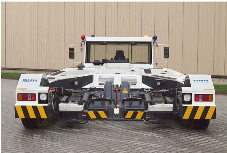
Slika 3.4 Nivelacija prema tipu zrakoplova tj. promjeru nosnog kotača
