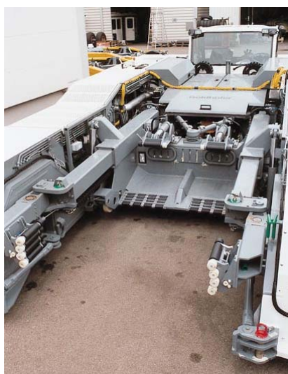
Slika 3.2 Podizna rampa vučnog vozila Goldhofer AST-2
