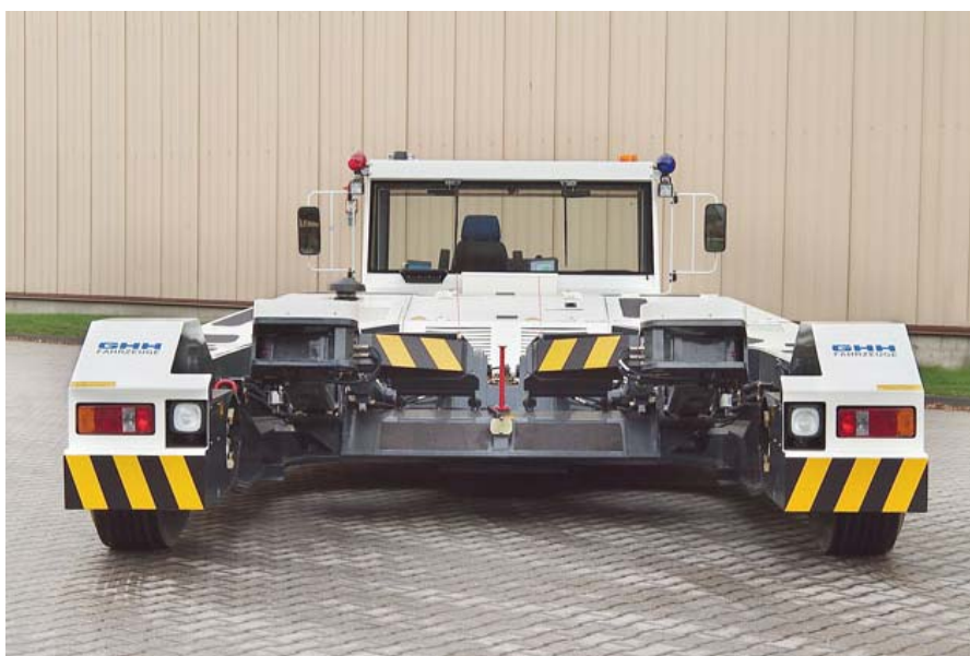
Slika 3.6 Podizanje nosne noge podvozja
