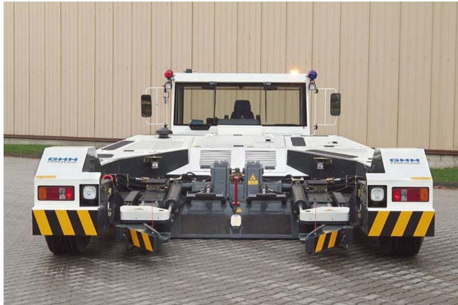
Slika 3.3 Podizna rampa u spuštenom položaju
