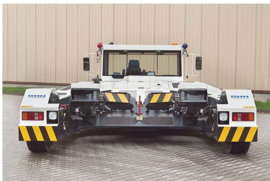
Slika 3.6 Podizanje nosne noge podvozja
