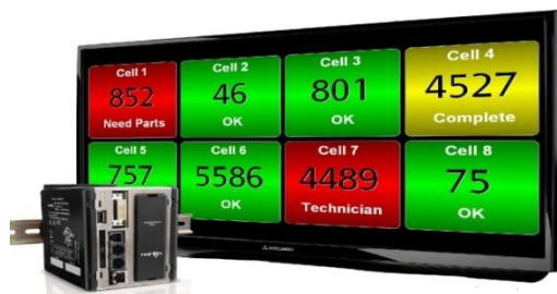
Slika 7. Andon vizualni sustav za praćenje linije [15]
