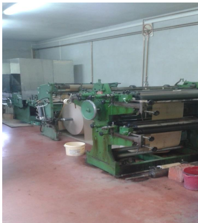
Slika 10. Prikaz stroja za izradu papirnatih vrećica
