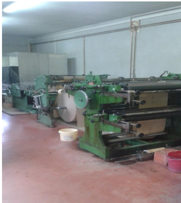
Slika 10. Prikaz stroja za izradu papirnatih vrećica
