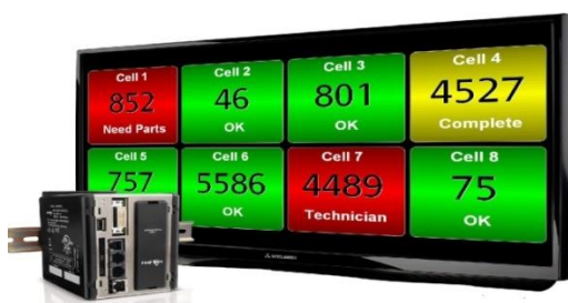
Slika 7. Andon vizualni sustav za praćenje linije [15]
