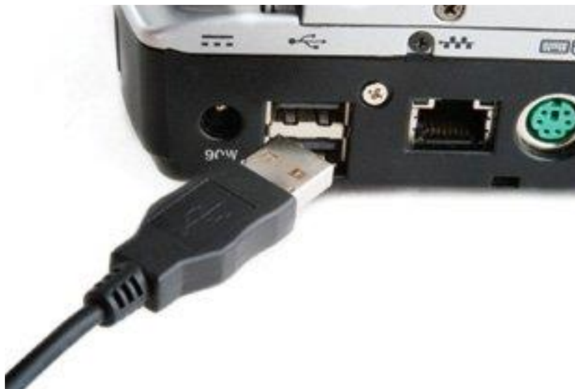
Slika 8. Primjer alata Poka-yoke[20]
