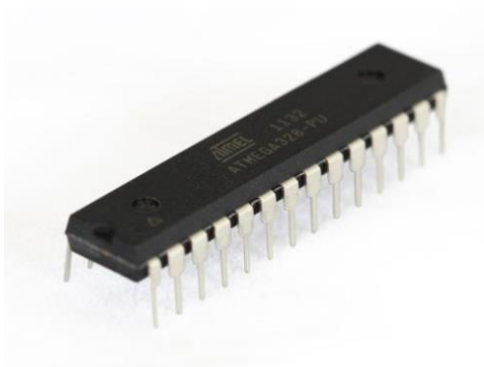
Slika 8 – Stvarni izgled ATmega328
