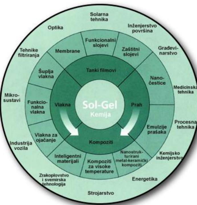
Slika 2 - Mogućnosti primjene sol-gel postupka [2]
