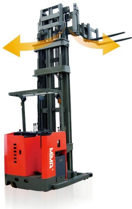
Slika 11. VNA viličar sa zakretnim vilicama [5]
