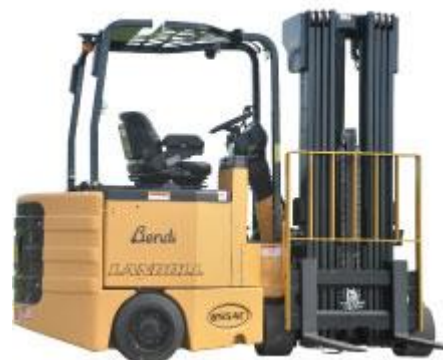
Slika 12. VNA viličar sa zakretnim jarbolom [6]
