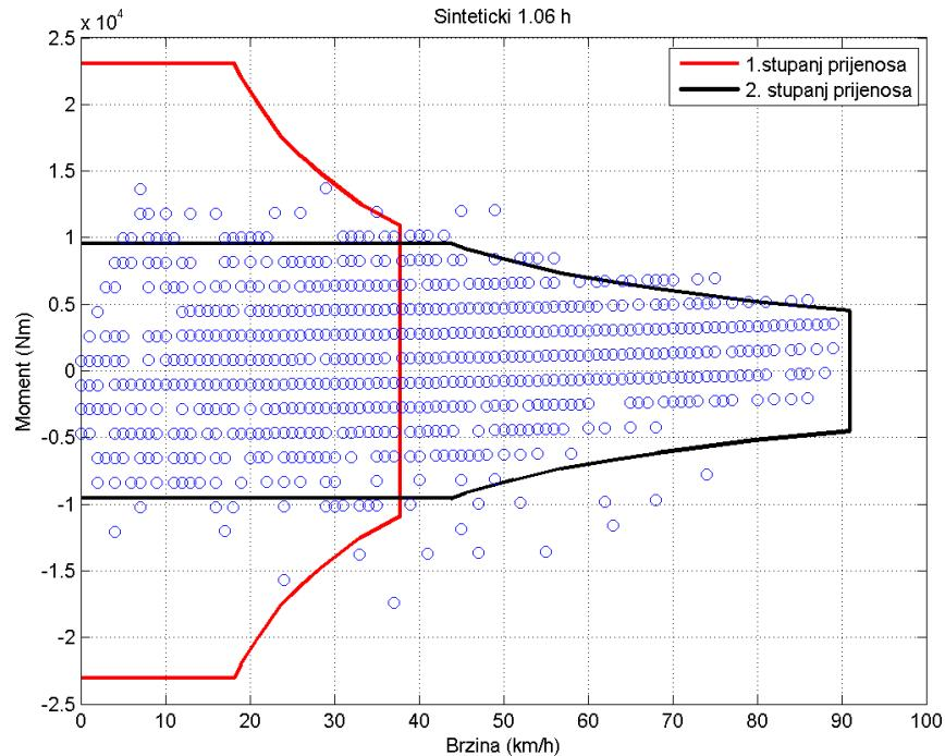
Slika 8. 6: Radne točke za sintetički ciklus trajanja 1.06 h
