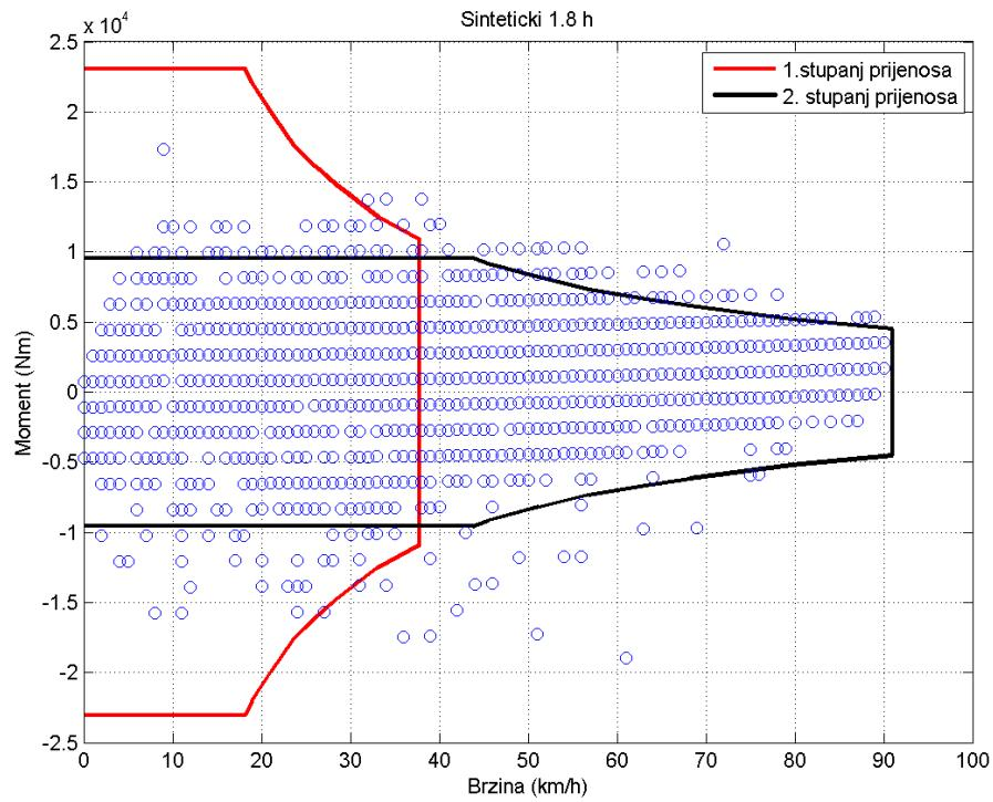
Slika 8. 9: Radne točke za sintetički ciklus trajanja 1.8 h
