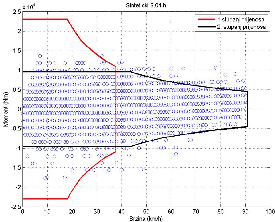
Slika 8. 10: Radne točke za sintetički ciklus trajanja 6.04 h
