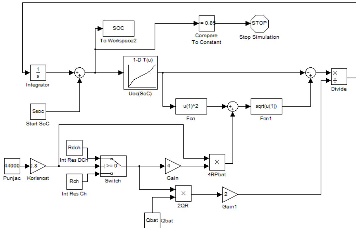
Slika 8. 3: Simulink model baterije s punjačem
