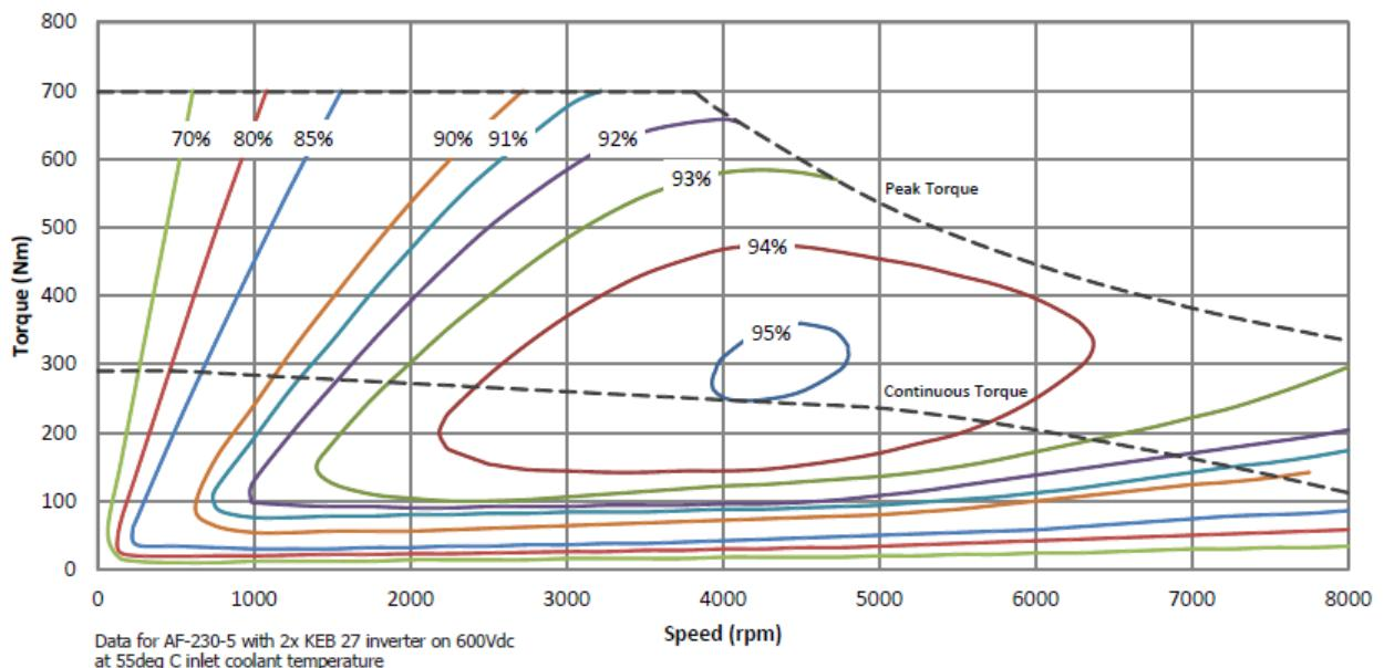
Slika 3. 3: Momentna karakteristika i karakteristika korisnosti motora/generatora EVO Electric AF – 230
