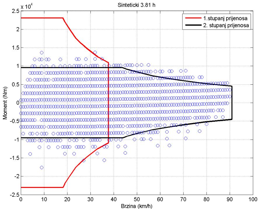
Slika 8. 8: Radne točke za sintetički ciklus trajanja 3.81 h
