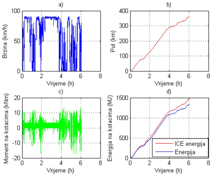
Slika 2. 7: Sintetički ciklus trajanju 6,04 h (vožnja autoputom): Brzina a), Put b), Moment na kotačima c), Energija d)
