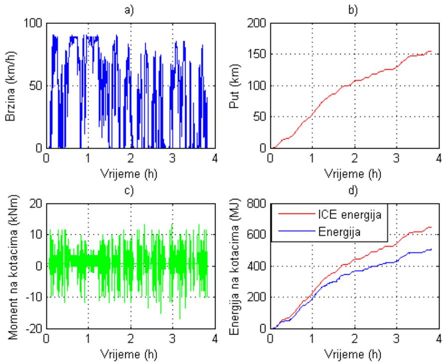
Slika 2. 6: Sintetički ciklus trajanju 3,81 h (medugradska vožnja): Brzina a), Put b), Moment na kotačima c), Energija d)
