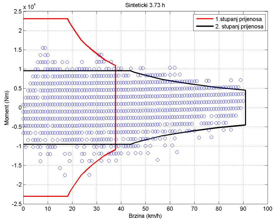
Slika 8. 7: Radne točke za sintetički ciklus trajanja 3.73 h
