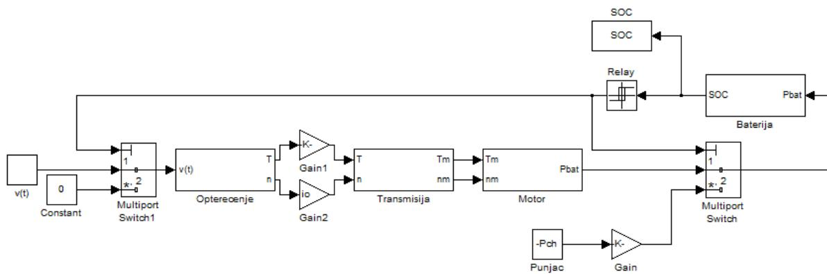
Slika 5. 2: Simulink model električnog dostavnog vozila
