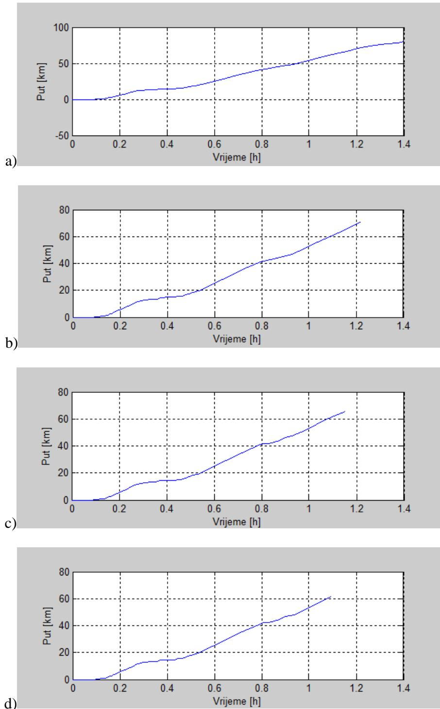
Slika 6. 6: Prijedjeni put za opterećenje: 0 kg a), 2000 kg b), 4000 kg c), 6000 kg d)
