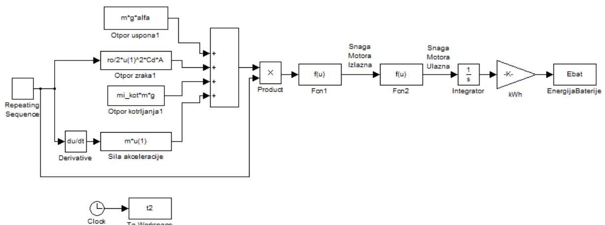
Slika 5. 1: Pojednostavljeni model vozila
