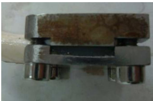
Slika 18. Tetiva stegnuta u čeljustima [9]
