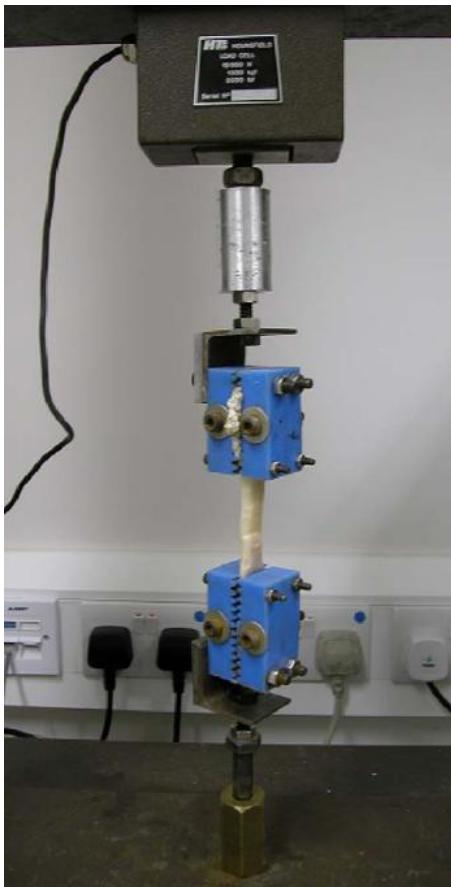
Slika 11. Statički vlačni test s nazubljenim čeljustima – model 1 [8]
