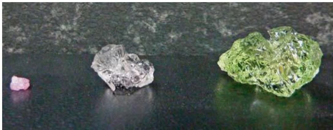
Slika 3.6. Pohranjivanje kapljevine u hidrogelu [5]
