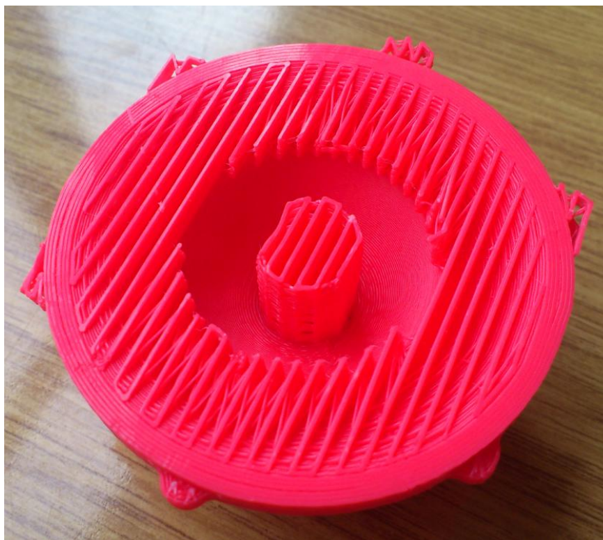
Slika 5.19. Središnji dio čašice s vidljivim potpornim dijelovima
