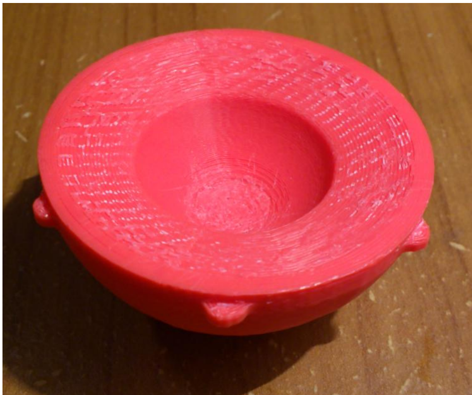
Slika 5.21. FDM model polimerne čašice implantata kuka
