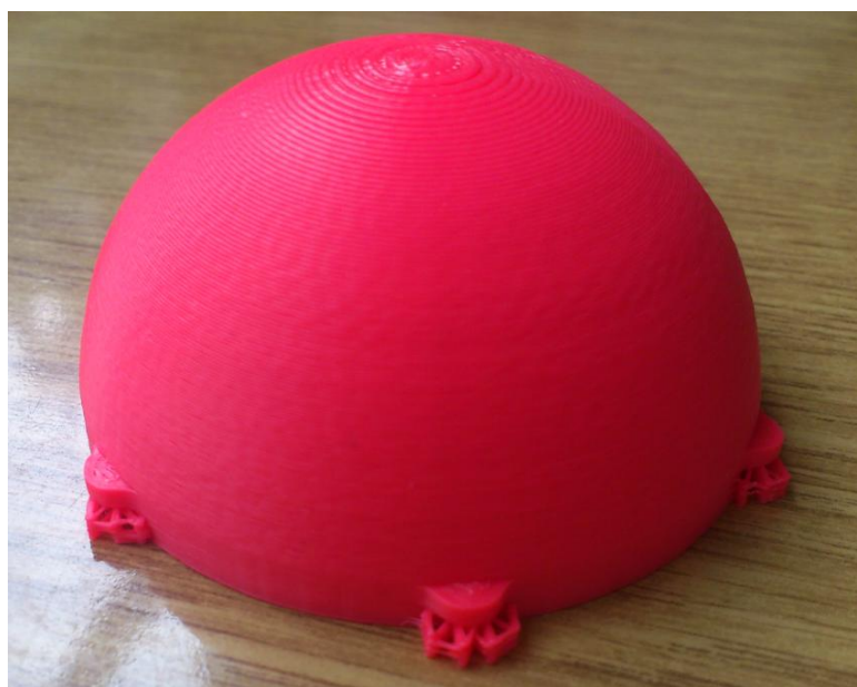
Slika 5.18. Proizvedeni model s potpornim dijelovima
