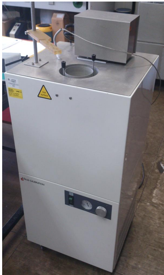
Slika 6. Heto Calibration KB 22 – 1 termostatorirana kupka
