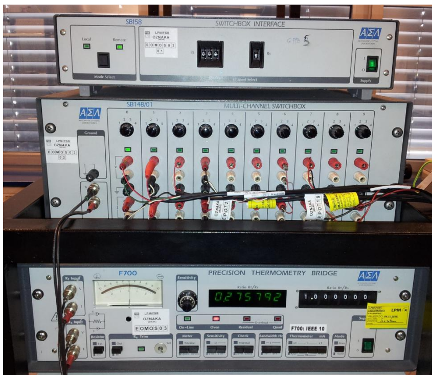
Slika 9. Termometrijski otpornički most ( spojene sve navedene komponente )
