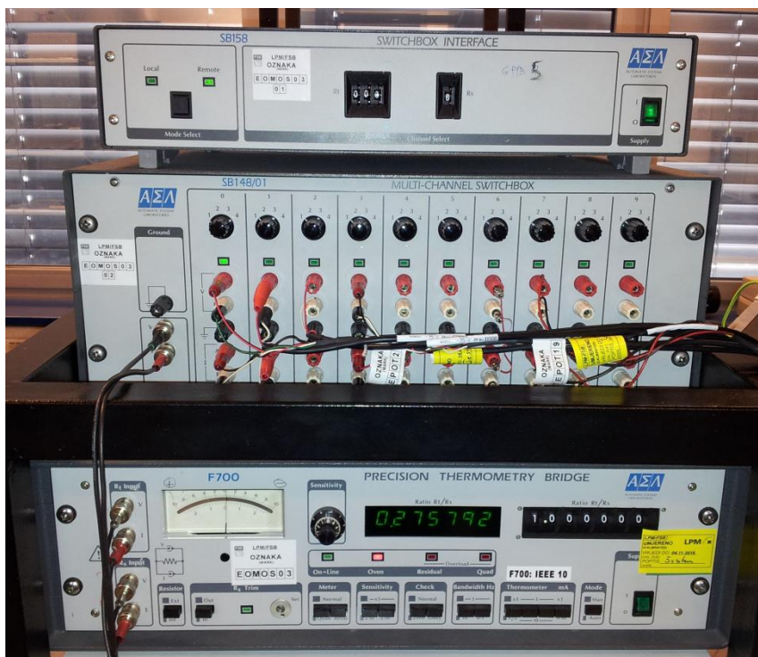
Slika 9. Termometrijski otpornički most ( spojene sve navedene komponente )
