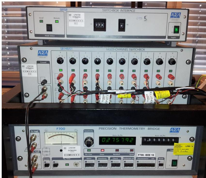
Slika 9. Termometrijski otpornički most ( spojene sve navedene komponente )
