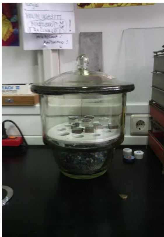
Slika 22. Eksikator za čuvanje uzoraka
