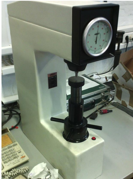
Slika 13. Uređaj za mjerenje tvrdoće materijala
