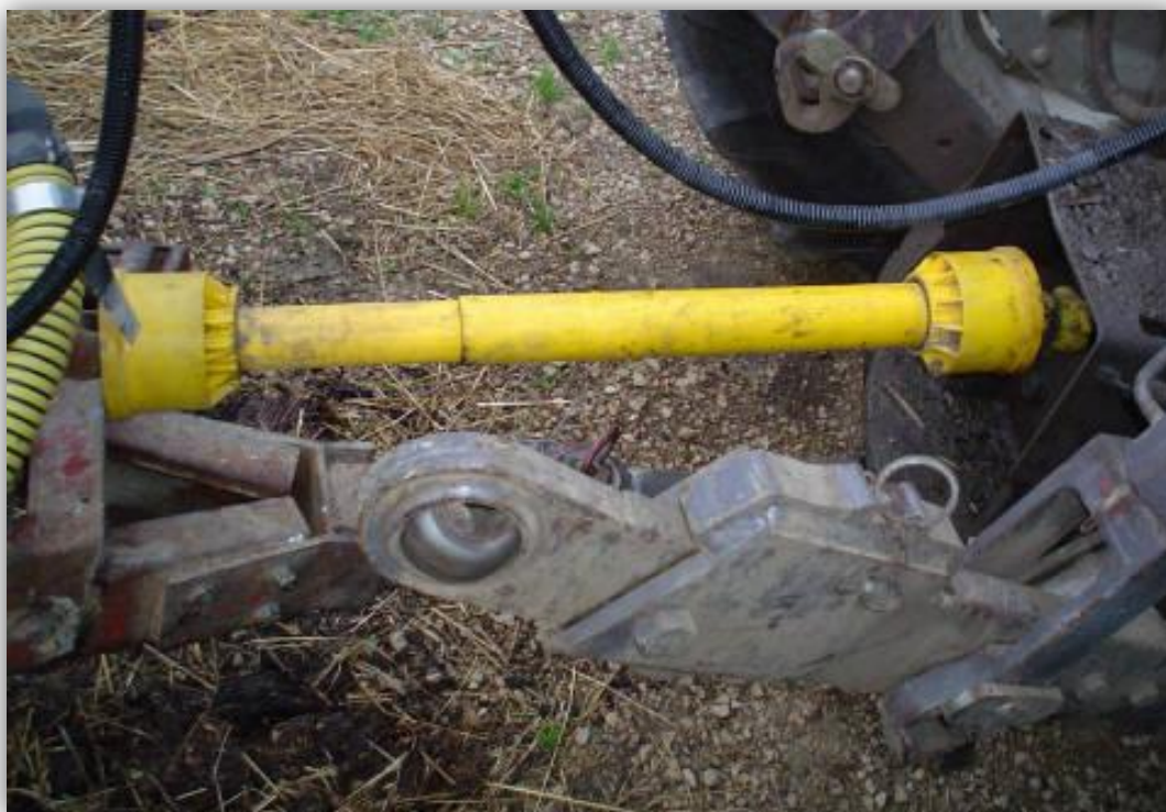
Slika 9. Priključak preko kardanskog vratila
