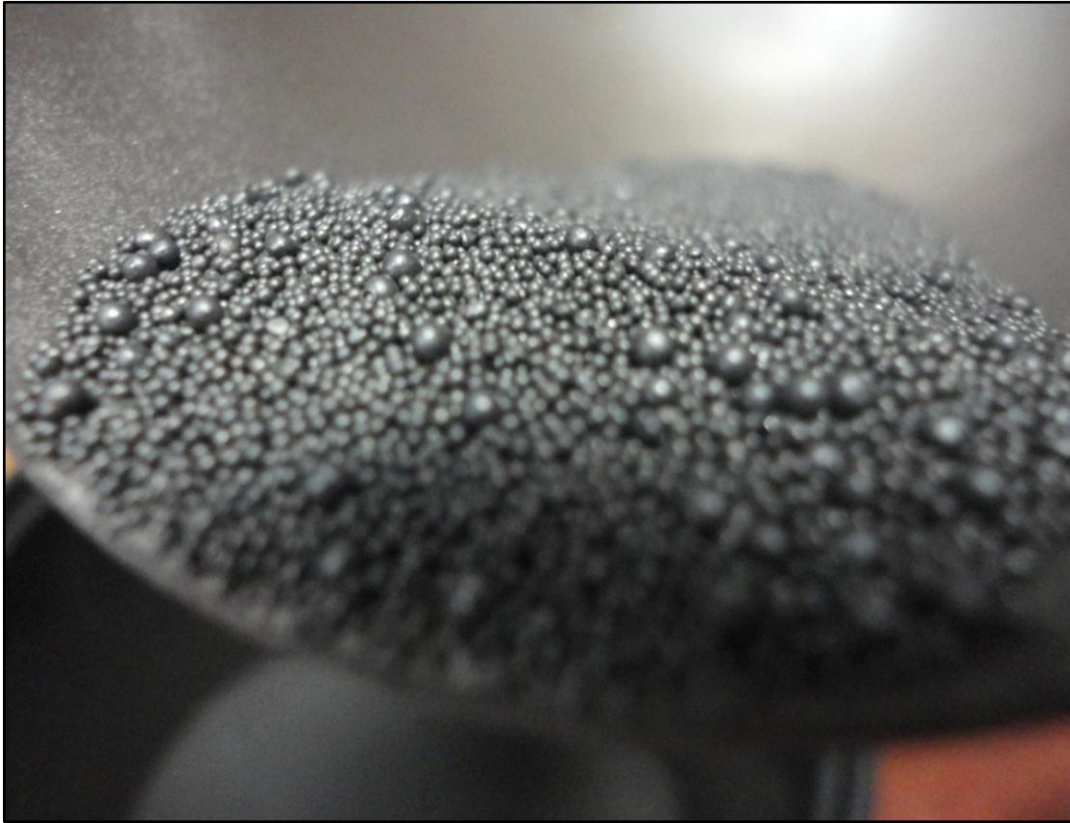
Slika 14. Prikaz čelične sačme promjera \sim 700 \mu\text{m}
