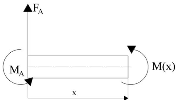
Slika 20 – Unutarnji moment savijanja u segmentu stupa
