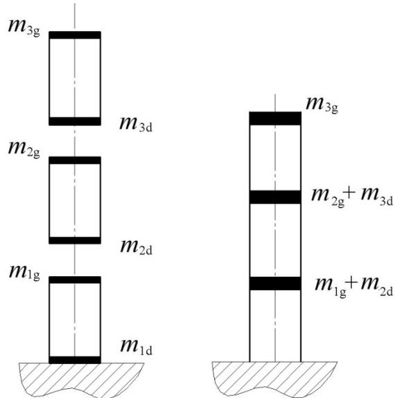
**Slika 15 - Razdvojeni i spojeni jednostavni segmenti stupa s prikazom raspodijele masa**
