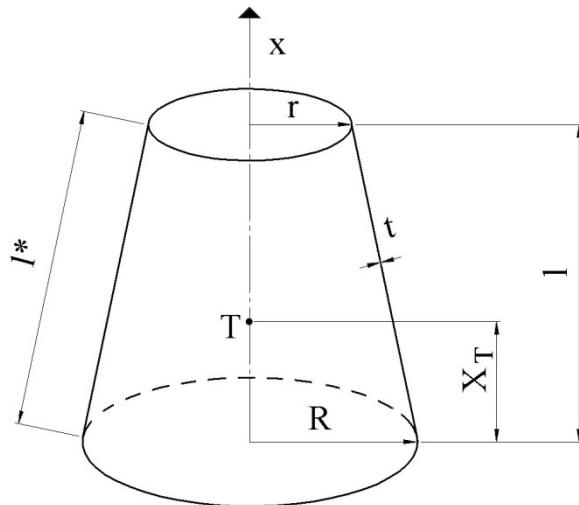
Slika 13 - Prikaz dimenzija jednog podsegmenta stupa
