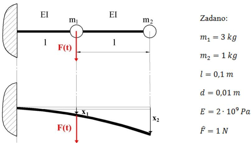
Slika 34 - Fleksijski vibracijski sistem s 2 stupnja slobode gibanja
