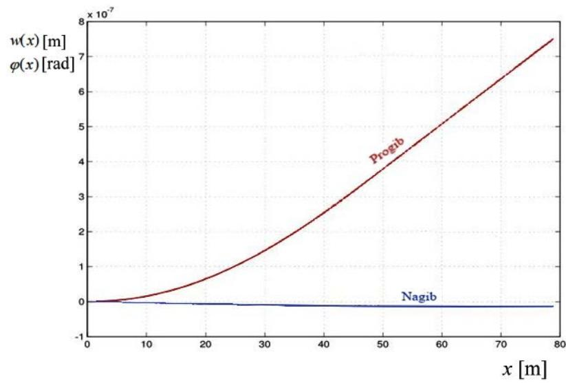
Slika 23 - Progibi i nagibi stupa uslijed sile  $F$  [14]
