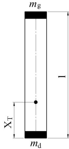
**Slika 14 - Diskretizacija mase jednostavnog podsegmenta stupa**
