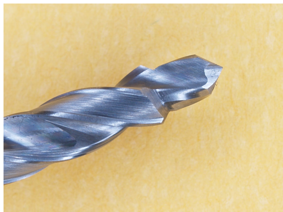
Slika 57. Oštrica dvostupnjevanog svrdla br.2 promjera 2,5/3,4 prije mjerenja
