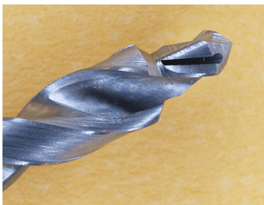
Slika 55. Oštrica dvostupnjevanog svrdla br.1 promjera 2,5/3,4 prije mjerenja
