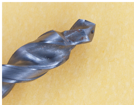
Slika 60. Oštrica dvostupnjevanog svrdla promjera 3,4/4,5 nakon 360 mjerenja
