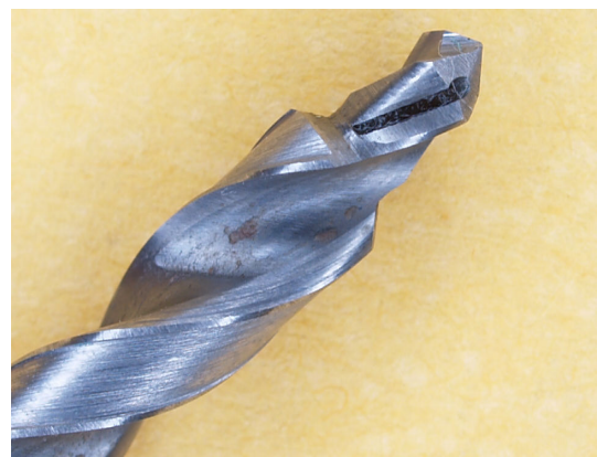
Slika 56. Oštrica dvostupnjevanog svrdla br.1 promjera 2,5/3,4 nakon 180 mjerenja
