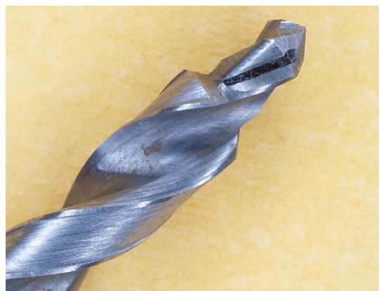
Slika 56. Oštrica dvostupnjevnanog svrdla br.1 promjera 2,5/3,4 nakon 180 mjerenja
