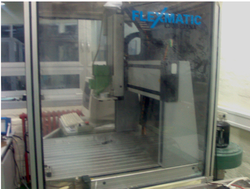
Slika 34. Portalna NU glodalica Flexmatic FA 530 S
