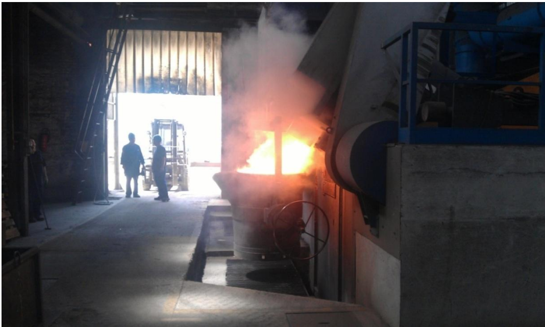
Slika 32. Ulijevanje primarne taljevine u lonac
