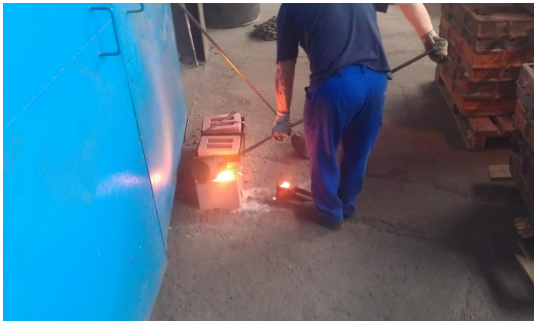
Slika 33. Lijevanje taljevine u kalupe
