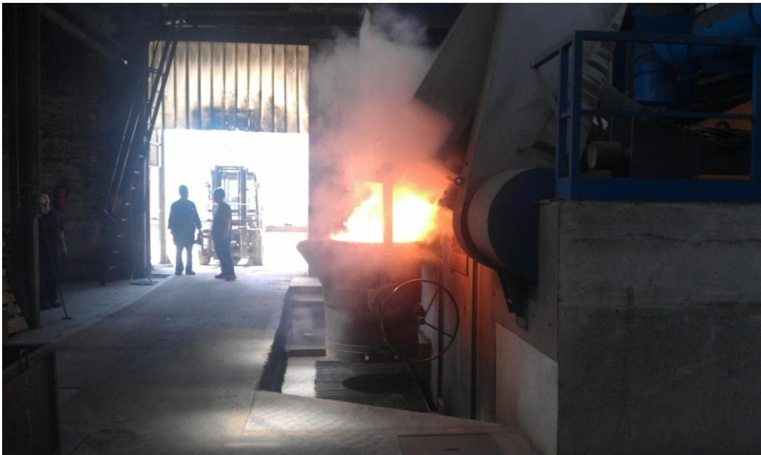
Slika 32. Ulijevanje primarne taljevine u lonac
