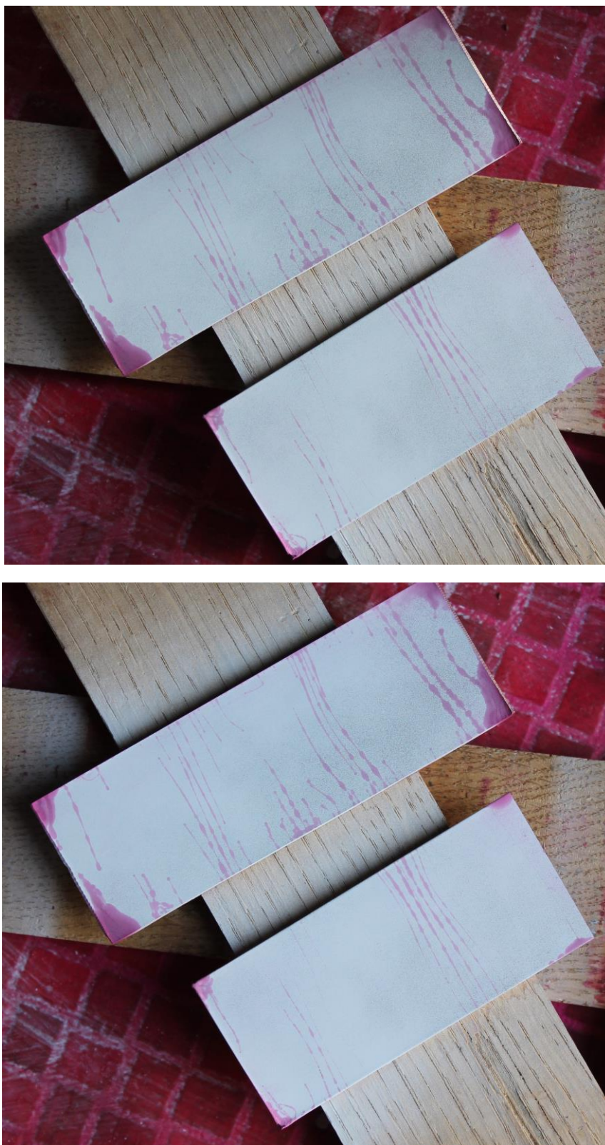
Slika 27. Indikacije na površinama etalona (gornja slika: T_{\text{pen}}=5 min, T_{\text{raz}}=20 min, E=300 lx, \vartheta=20^{\circ}\text{C} donja slika : T_{\text{pen}}=5 min, T_{\text{raz}}=20 min, E=800 lx, \vartheta=20^{\circ}\text{C} )
