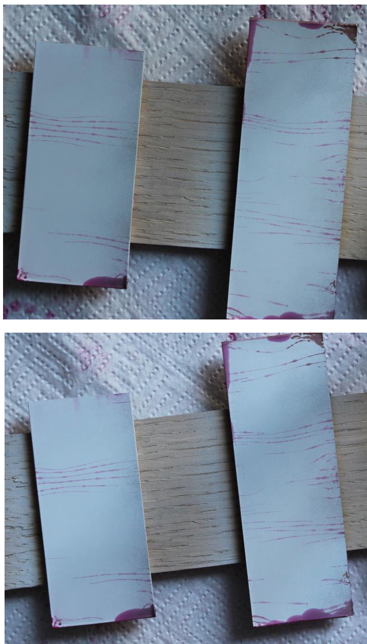
Slika 19. Indikacije na površinama etalona (gornja slika: T_{pen}=5 min, T_{raz}=10 min, E=300 lx, \vartheta=21^{\circ}\text{C} donja slika : T_{pen}=5 min, T_{raz}=10 min, E=800 lx, \vartheta=21^{\circ}\text{C} )
