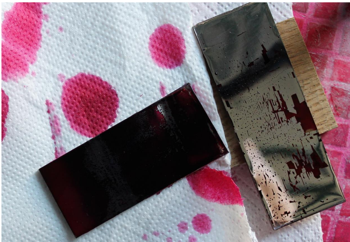
Slika 16. Ispareni penetrant na etalonu 1
