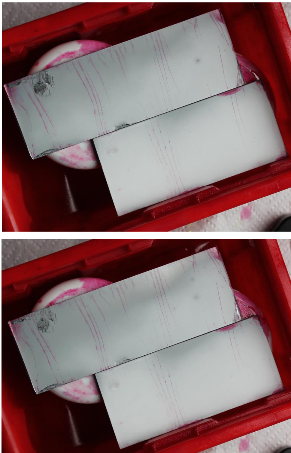
Slika 22. Indikacije na površinama etalona (gornja slika: T_{\text{pen}}=15 min, T_{\text{raz}}=20 min, E=300 lx, \vartheta=7^{\circ}\text{C} donja slika : T_{\text{pen}}=15 min, T_{\text{raz}}=20 min, E=800 lx, \vartheta=7^{\circ}\text{C} )
