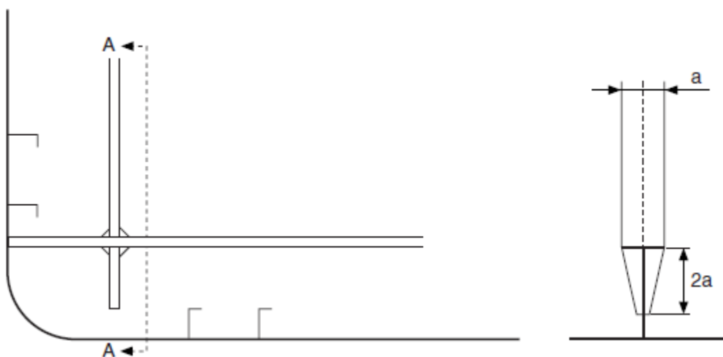
Slika 42. Spajanje dvaju primarnih nosećih elemenata
