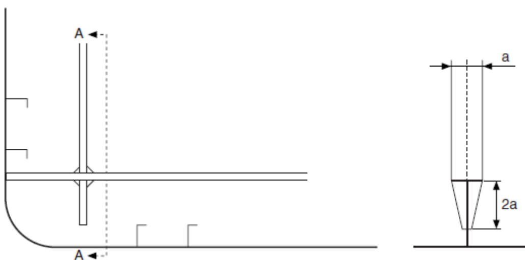
Slika 42. Spajanje dvaju primarnih nosećih elemenata
