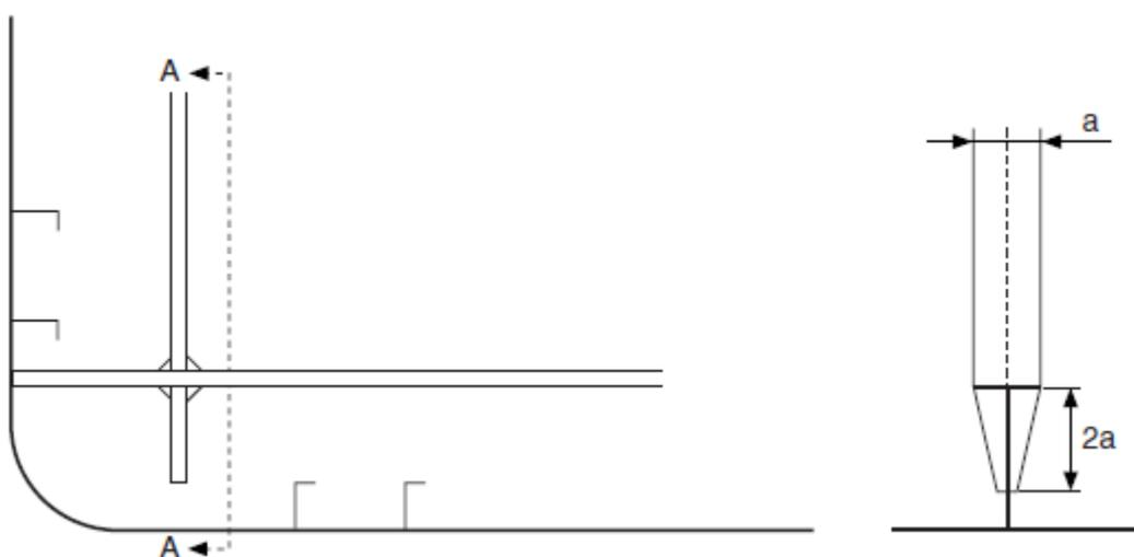
Slika 42. Spajanje dvaju primarnih nosećih elemenata
