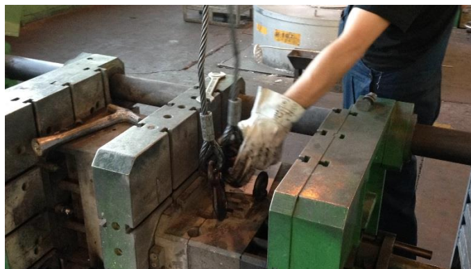
Slika 29. Odspajanje nove kokile sa mostne dizalice
