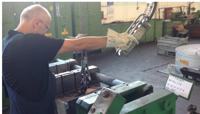
Slika 23. Spajanje kokile na mostnu dizalicu
