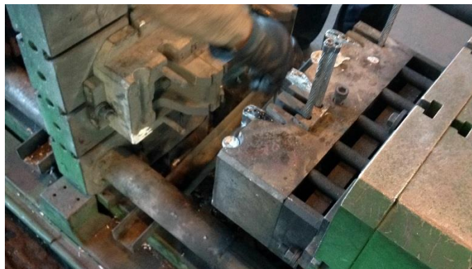
Slika 40. Hlađenje odljevka na zraku
