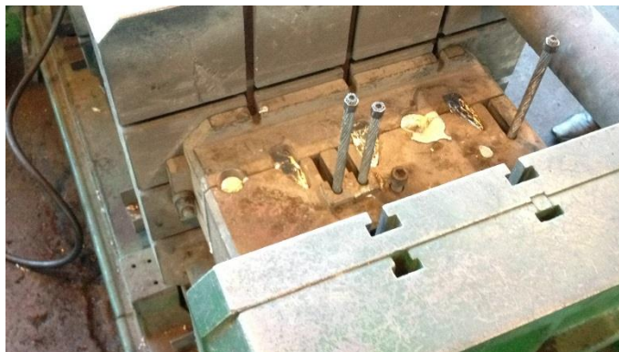
Slika 37. Lijevanje hvataljke sa užetom u kokili
