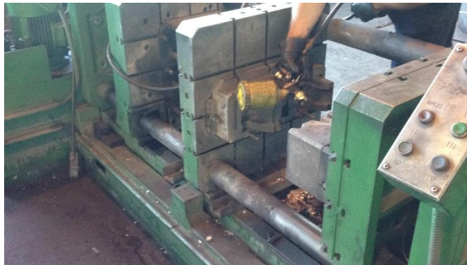
Slika 36. Špricanje kokile tekućinom
