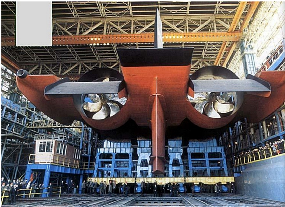
Slika 42. Vijci Typhoon klase [41]
