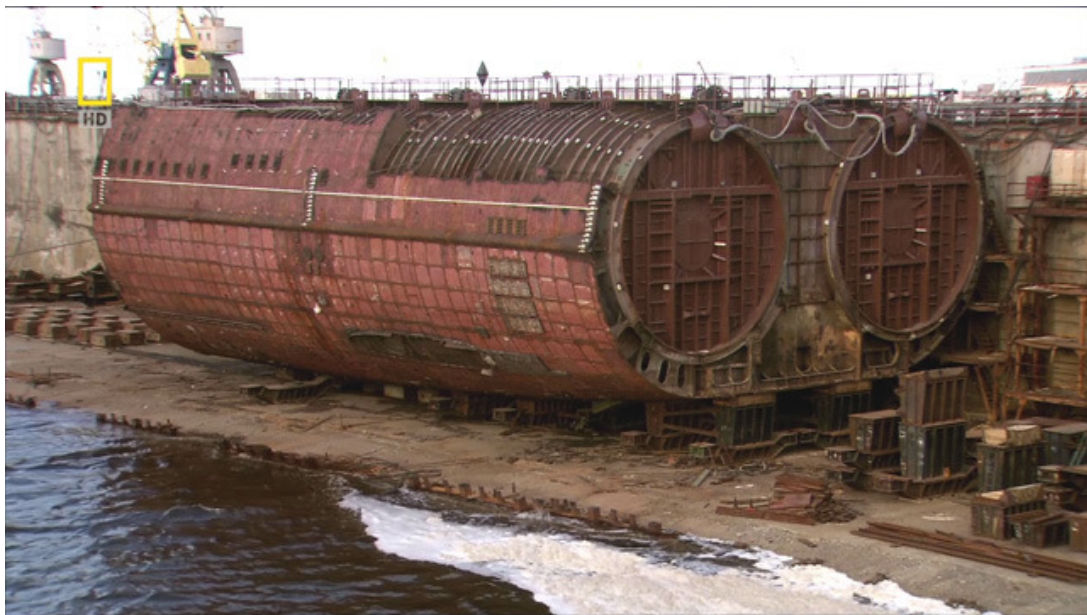
Slika 15. Izvađeni dio trupa s nuklearnim reaktorom [16]
