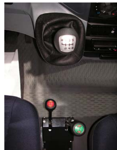
Slika 11. Ručice mjenjača, splitera i redukcija [11]
