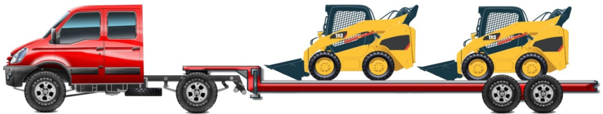
Slika 40. Koncept lakog tegljača građevinskih strojeva i opreme najveće dopuštene ukupne mase 5t
