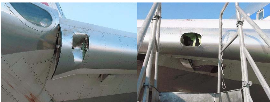
Slika 1.1. Oštećenja na pretkrilcu nastala uslijed udara ptice [2]
