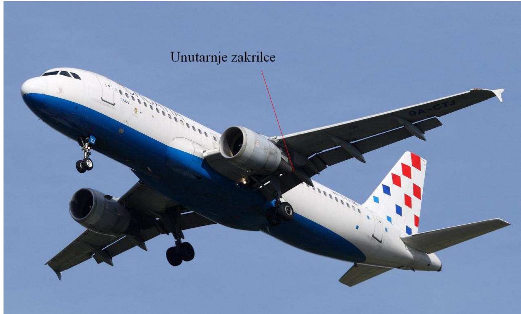
Slika 2.12. Airbus A319 sa označenim položajem zakrilca [3]
