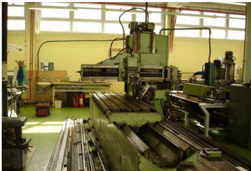
Slika 3.5. Dugohodna blanjalica u Laboratoriju za alatne strojeve, FSB, Zagreb
