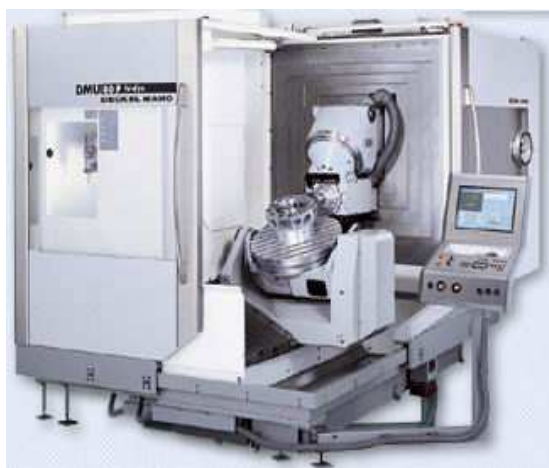
b) Numerički upravljani CNC stroj
