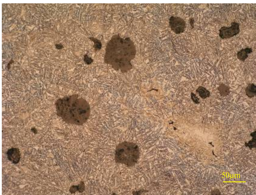
Slika 32 – Mikrostruktura uzorka u nagriženom stanju, povećanje 200x
