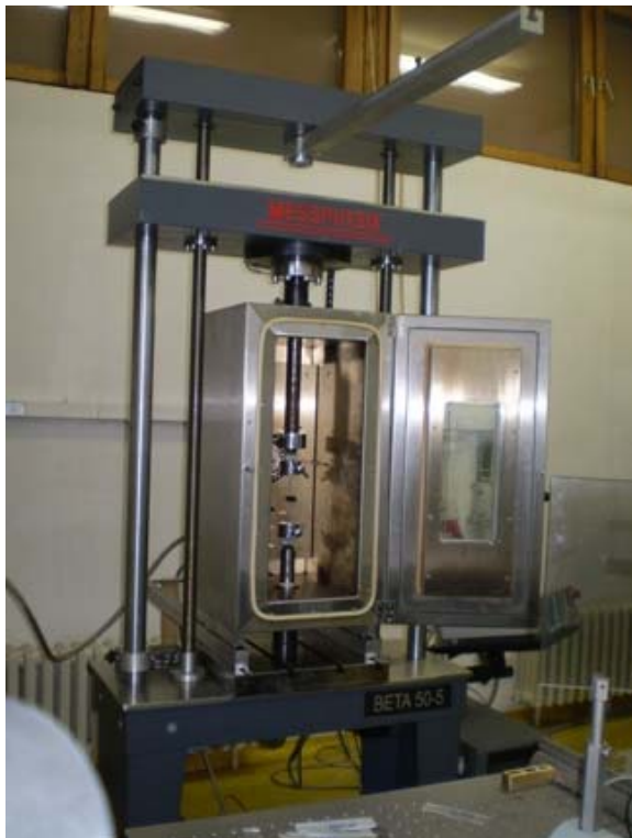
Slika 6.5. Komora i kidalica spremne za ispitivanje
