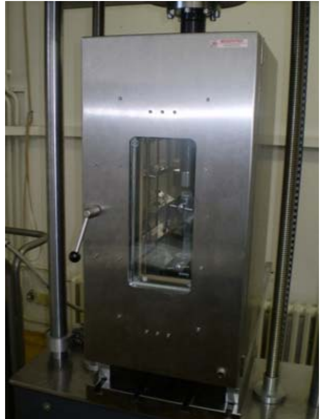
Slika 6.4. Komora za temperiranje
