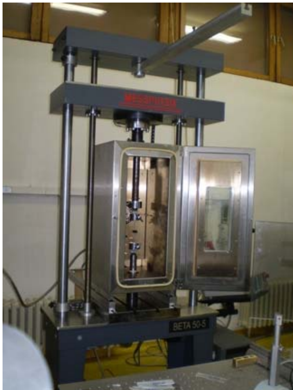
Slika 6.5. Komora i kidalica spremne za ispitivanje
