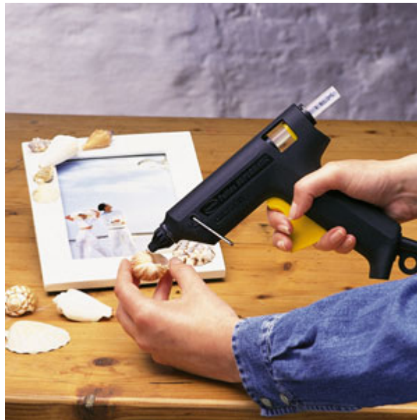
Slika 3.4. Pištolj za nanošenje ljepila [5]
