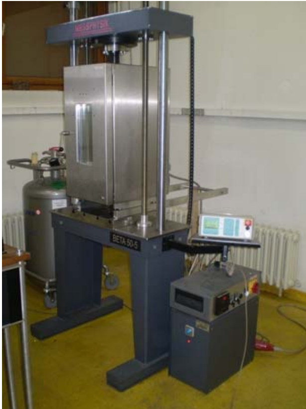
Slika 6.3. Kidalica MESSPHYSIK BETA 50-5
