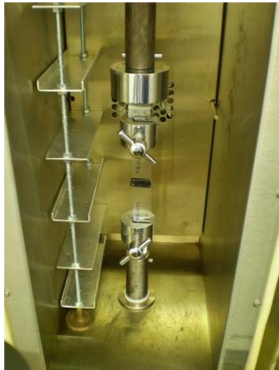
Slika 6.6. Ispitno tijelo stegnuto u hvataljke
