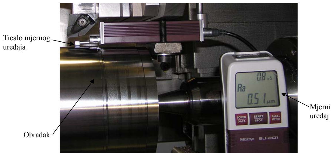
Slika 38. Mjerni uređaj u poziciji za mjerenje
