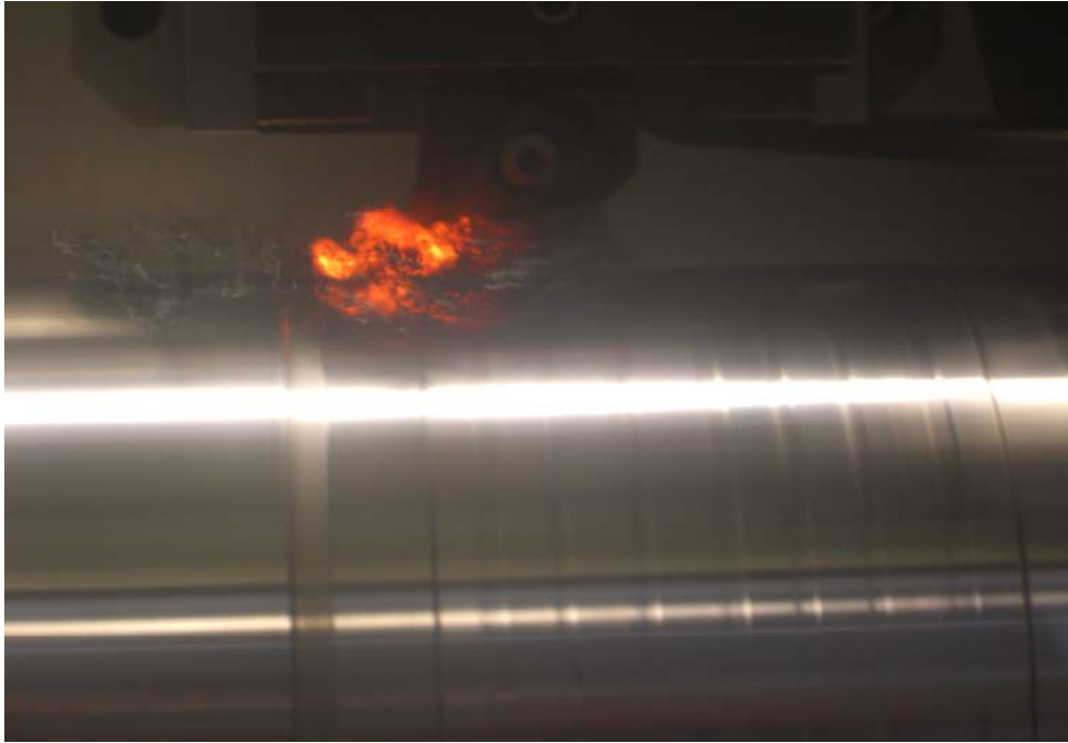
Slika 54. Omatanje kontinuirane odvojene čestice oko noža pri režimima obrade
