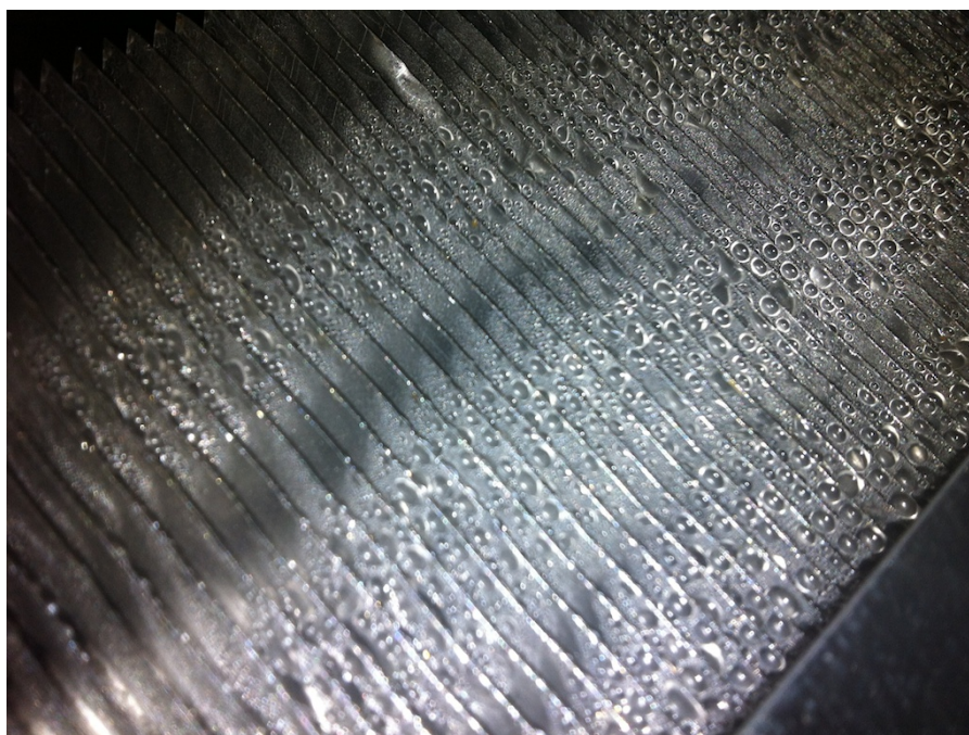
Slika 85. Prikaz kondenzata na lamelama izmjenjivača
