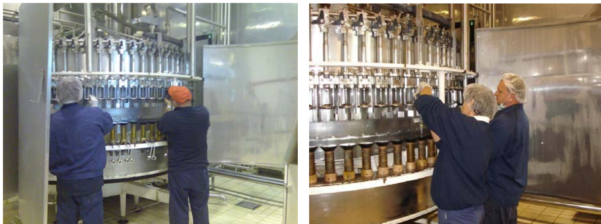
Slika 4.3.3.7. Podešavanje dizni i postavljanje CIP časića
