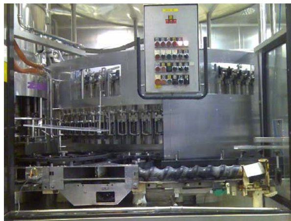
Slika 4.2.1.4. Stroj za punjenje (Hansa)
