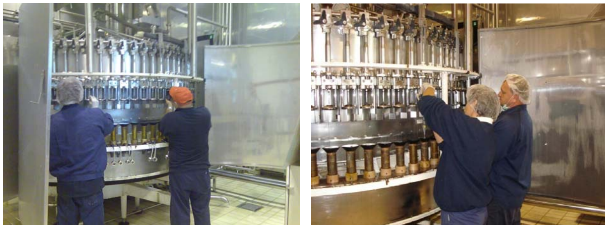
Slika 4.3.3.7. Podešavanje dizni i postavljanje CIP časičica
