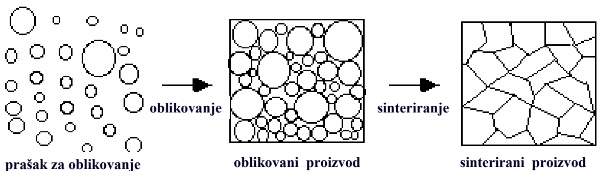
Slika 7. Zgušnjavanje mase oblikovanjem za daljnu obradu (sinteriranje)
