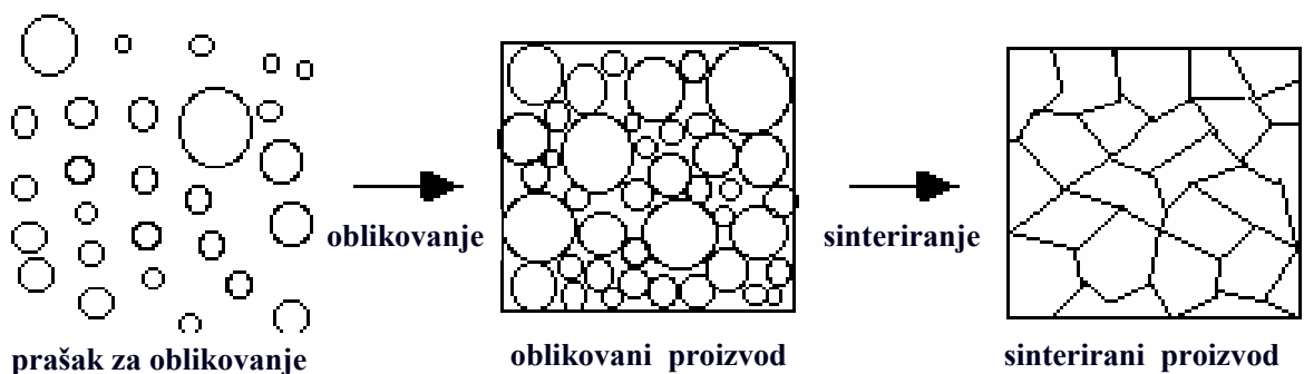
Slika 7. Zgušnjavanje mase oblikovanjem za daljnu obradu (sinteriranje)
